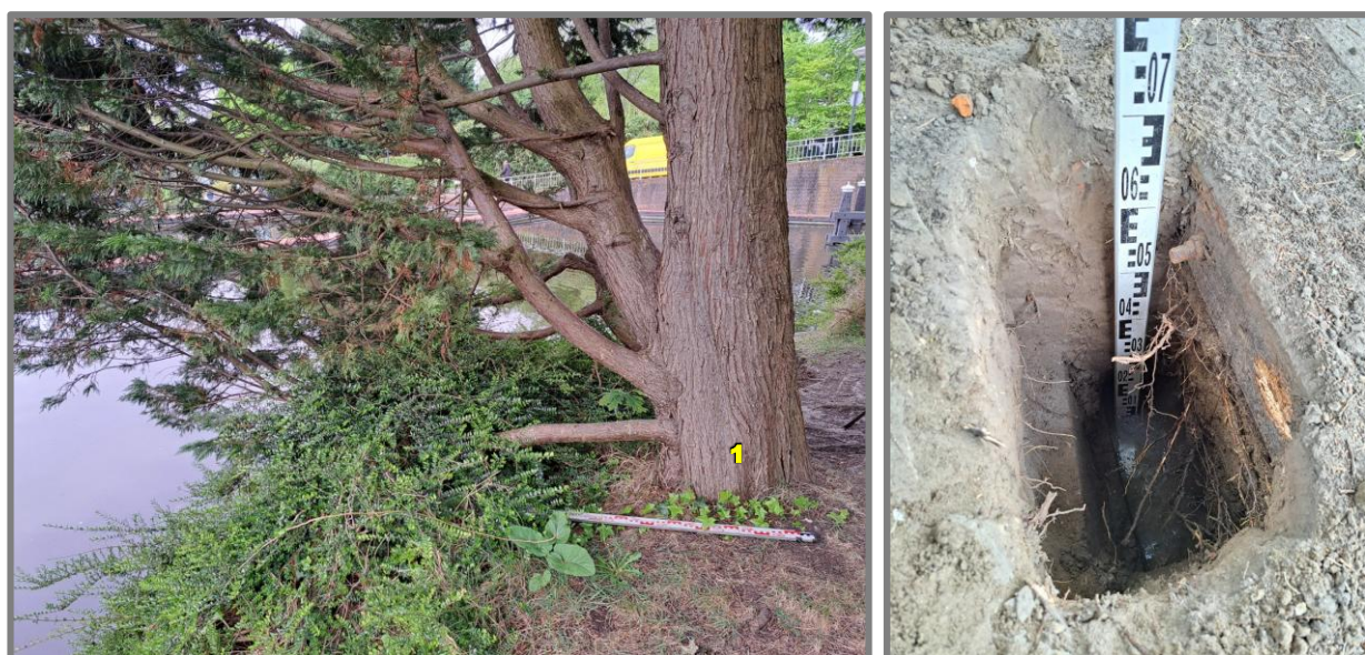
Fig. 2: Voor de vervanging van de beschoeiing zal boom 1 zeer zwaar gesnoeid moeten worden (links). Dit kan gevolgen hebben voor de conditie van de boom en voor de breukgevoeligheid van de bomen omdat de windbelasting op de boomgroep dan verandert. In een proefsleuf vlak achter de beschoeiing bij boom 4 is grondwater op 60 cm diepte aangetroffen. De grondwaterstand belemmert verdere dieptegroei van boomwortels en daarmee de ruimte die eventuele nieuwe bomen tot hun beschikking hebben. Na het vervangen van de beschoeiing is het verstandig om een verticaal wortelscherm op enige afstand van de beschoeiing aan te brengen om toekomstige wortelgroei tegen/door de beschoeiing te voorkomen.
